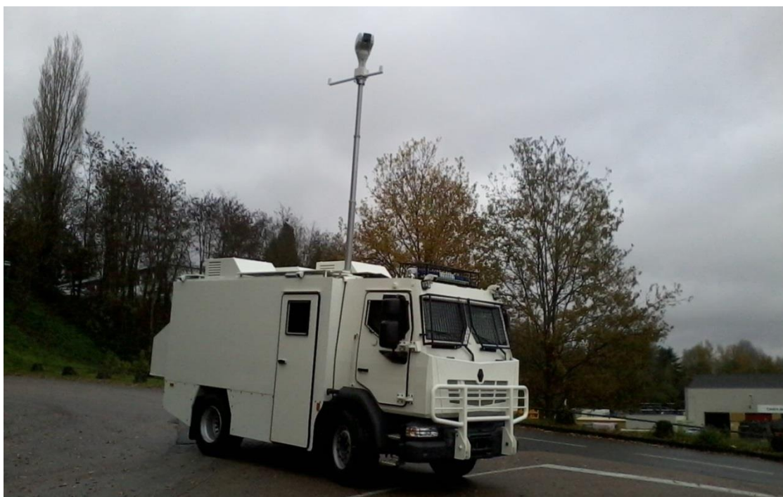
Une caméra orientable sur 360°, installée sur un mât déployable, assure l'observation longue portée
